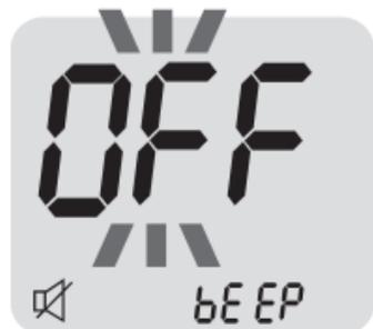
**10. Ligando ou desligando o aviso sonoro:** O glicosímetro está configurado com o aviso sonoro ligado. Para modificar para desligar, aperte "<" ou ">" até que "OFF" (desligado) apareça, então aperte
