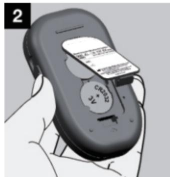
1. Quando as baterias estão fracas aparecerá na tela e piscará o ícone de bateria fraca no canto superior esquerdo. Isto indica que há bateria suficiente para cinquenta testes e a bateria deverá ser trocada. Trocando as baterias, seus resultados serão armazenados no glicosímetro, entretanto deverá ajustar data e horário.
